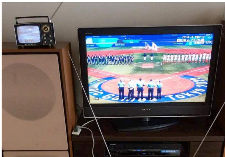
右は我が家の 32インチ液晶テレビ。そろそろ 4K テレビに買い換えた方が良くご老体だが、32インチなどという小さなサイズは売っていない。別に 4K が見たい訳ではないけれど、オーディオの方が大切な我が家、これ以上大きなものは、6畳の部屋には入らない。左上が同じ画面をモノクロで映すソニー。どうして、半世紀前のテレビと一緒に映るのか？手前に V字型に見える角状アンテナがヒント。デジタル画像をアナログに戻して、電波で飛ばしているのである。
